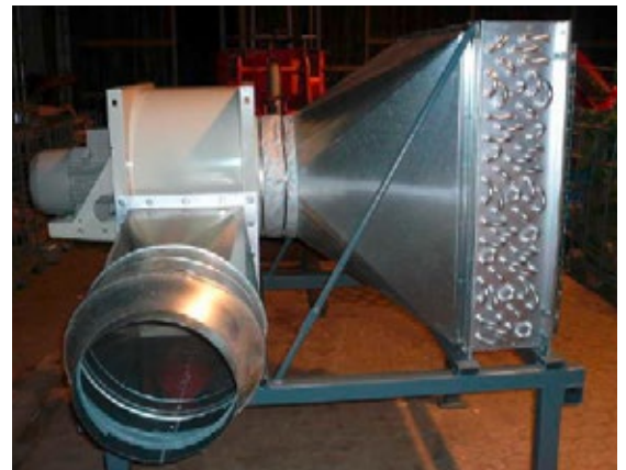
Abb. Ventilator-Wärmetauscher-Einheit Holz- oder Hackschnitzeltrocknung
